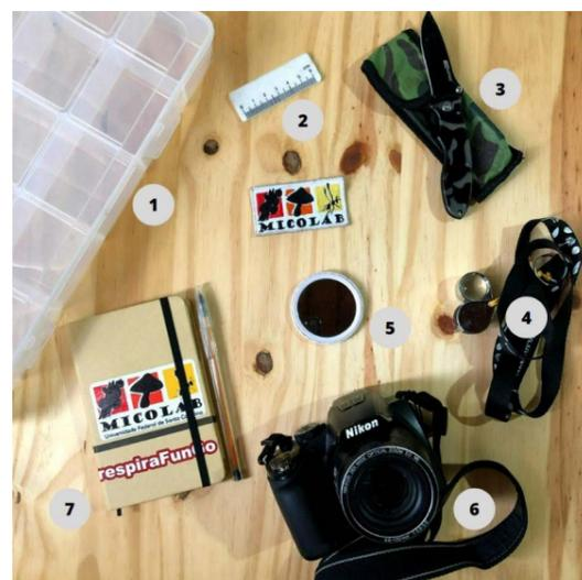
Figura 2. Materiais para coleta: 1) Caixa; 2) Escala; 3) Canivete; 4) Lupa de mão; 5) Espelho; 6) Máquina fotográfica (celular); 7) Caderno. Foto M.E.A.B.
